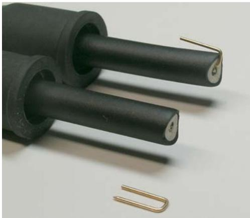
Die Hochspannungskabel werden nach dem Verlegen auf die passende Länge gekürzt und vor dem Verkrimpen mit einer Crampe kontaktiert. Nur durch die Crampe wird sichergestellt, dass die Zündspulen-Energie sicher auf die Edelstahlspirale des Kabels geleitet wird.
