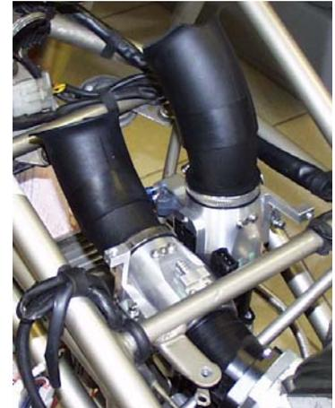
Bei der 900M muss der linke Body unter einem Querrohr verlaufen und daher wird für den Trichter ein neues Loch nötig.
