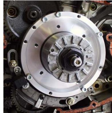
statische Einstellung am Pickup verlassende Schraubenkante -> ca. Mitte Pickup-Kern für den stehenden Zylinder (rechts) bei ca. 8° vOT.
