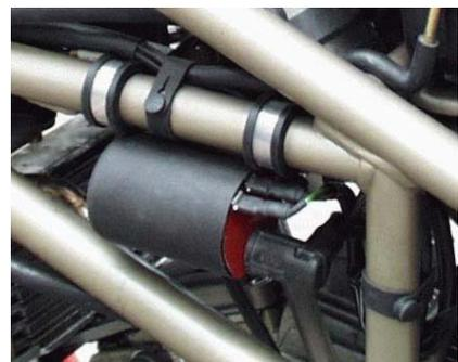
Montage der Spulen mit Kühlung durch Fahrtwind
