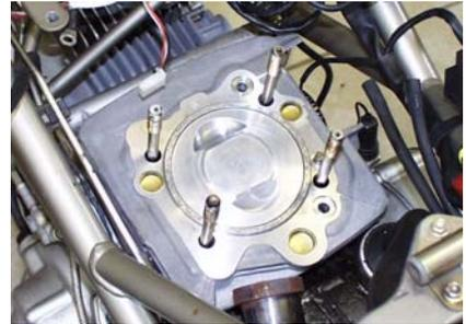
Es erleichtert die Arbeit, wenn zunächst auf dem Werkstisch der Kolben im Zylinder montiert wird und dann der Satz weiter an das Pleuel verbaut wird.
