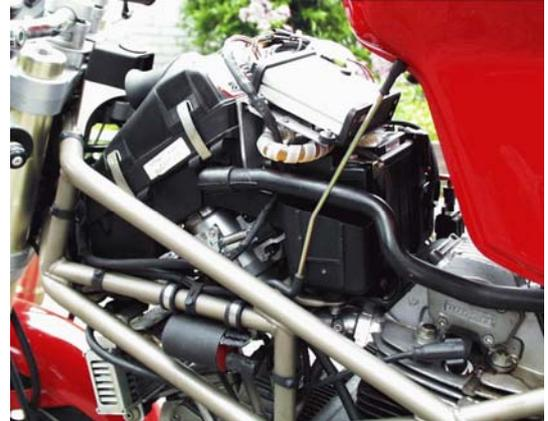
ICM-Box an Ducati 900M mit Serien-Airbox und kleiner Hawker-Batterie. Zündspulen sind am Rahmenrohr.
