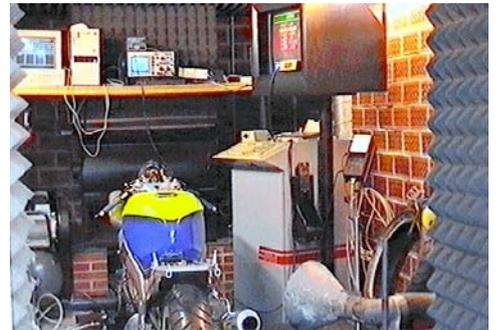
Die Vollgas-Abstimmung kann auf einem Prüfstand oder auch auf der Autobahn erfolgen.
