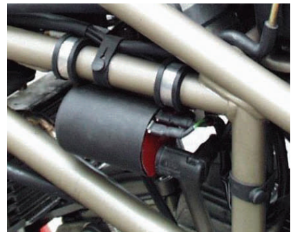
Montage der Spulen mit Kühlung durch Fahrtwind
