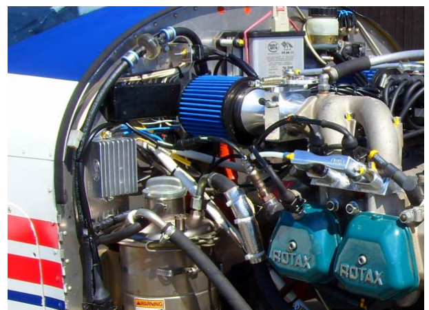
Montage in der Front mit guter Kühlung durch Fahrtwind und max. 50cm Zuleitung zur Batterie
