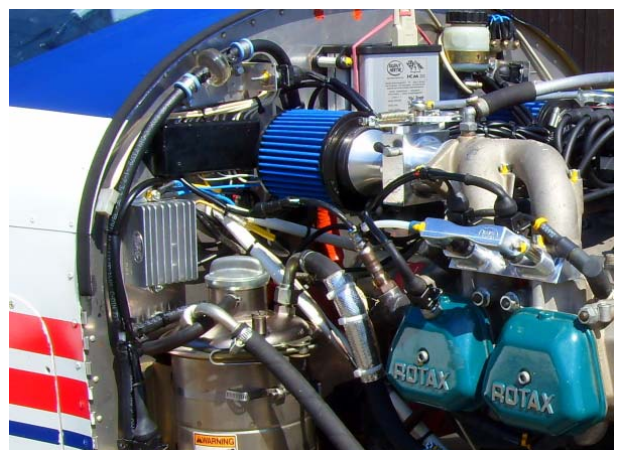
Montage in der Front mit guter Kühlung durch Fahrtwind
