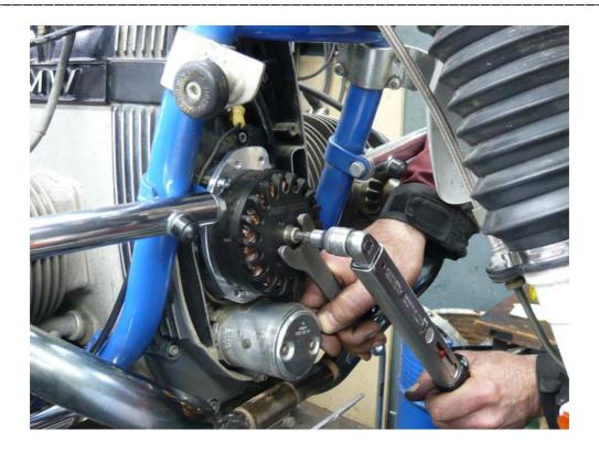
Grundeinstellung des LiMa-Rotors für die PowerBlock Zündung:
