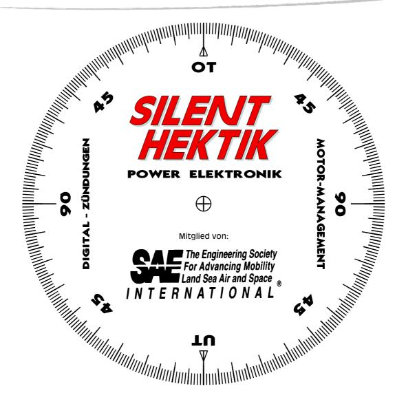
Grundeinstellung des LiMa-Rotors für die PowerBlock Zündung:
