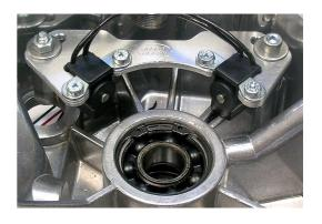
Doppelfunken-Zündspule optimal am Rahmen montiert
