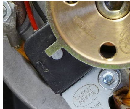
Der Induktivsensor hat einen Widerstand von 500 Ohm
