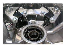
Doppelfunken-Zündspule optimal am Rahmen montiert
