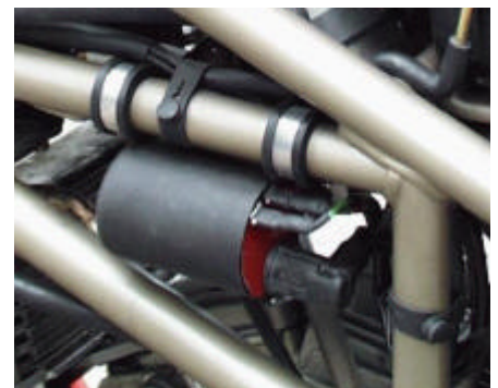
Zündspule optimal am Rahmen montiert
