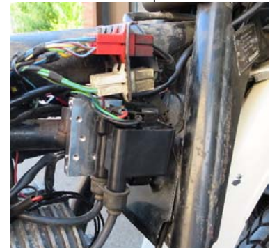
Abstand der Zündbox zur Spule sollte min. 15cm sein
