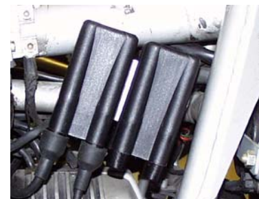
Zwei TwinCoil für Dop.-Zündung. Bei G/S Modellen muss ein Stecker verschoben werden
