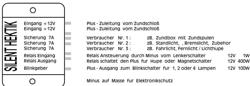
Die Zuleitung vom Zundschoß sollte in 2x 1.5qmm, alle anderen Anschlüsse sollten auch in 1.5qmm erfolgen. Bitte achten Sie auf eine gute Masseverbindung, um keine elektr. Schaden am Modul zu verursachen. Bitte alle Steckverbinder mit **Kontaktfett** vor Feuchtigkeit schützen. Kein Polfett, da alkalisch.
