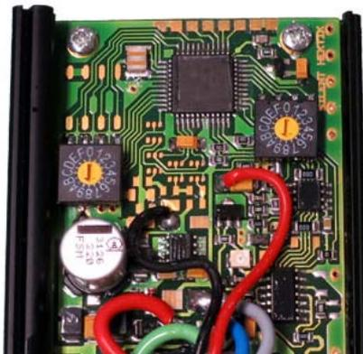
Durch lösen der vier Schrauben an den Haltewinkeln kann die obere Halbschale entfernt werden. Im Inneren der Box sind zwei Schalter.
