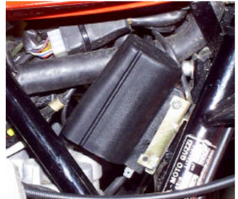
Montage der Zündspulen (SoloCoil) im Original-Halter mit Kühlung durch Fahrtwind
