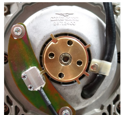
Montage des Hall-Gebers an der SAPRISA-LiMa mit orig. M5 Schrauben und zwei Distanzen Abstand mittig zum Alugehäuse 0,6-0,8mm
