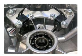
Doppelfunken-Zündspule optimal am Rahmen montiert
