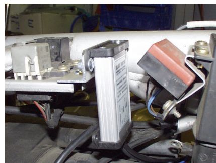
Abstand der Zündbox zur Spule sollte min. 10cm sein
