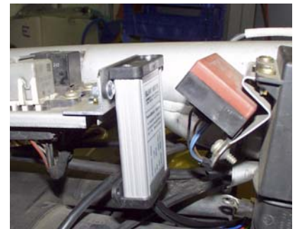
Abstand der Zündbox zur Spule sollte min. 15cm sein
